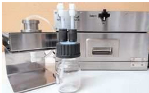
図-11 e-nose ニオイセンサー (アロマコーダー) の外観。線虫感染ニンニクに特徴的な匂いを 35 種の QCM 素子で詳細に分析することが可能である。
