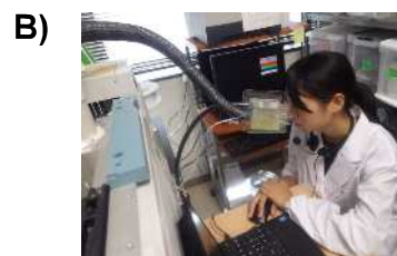
図-9 におい嗅ぎガスクロマトグラフ (GC-O). A) 概念図, B) パネルによる GC-O 分析の様子.
