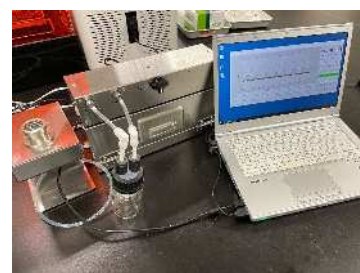
図-3 e-nose ニオイセンサーの外観。
