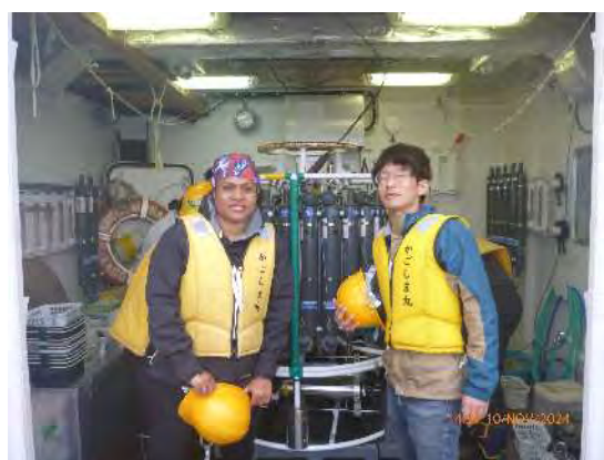
3) 海洋観測体験: CTD システム(水温、塩分を鉛直方向に連続的に計測しながら、任意の深度で採水することができる観測機器)の準備を、実習生のマラマさんと藏菌さんが担当しているところ。
