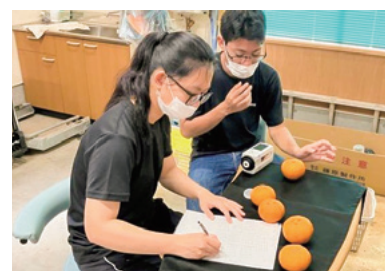
色差計によるカンキツ果皮色の調査 Investigation of Citrus Peel Using a Color Reader
